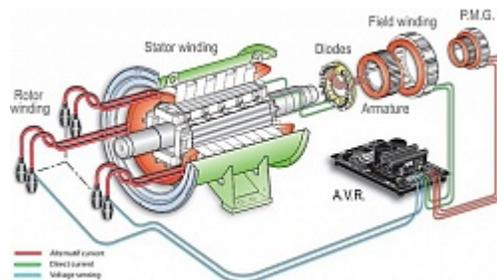
В большинстве случаев генераторы других производителей поставляются с питанием автоматического регулятора напряжения от основных обмоток. Таким образом в момент просадки напряжения при подключении дополнительной нагрузки, AVR не получает достаточного питания и выдерживает перегрузки по току только до 180%.
