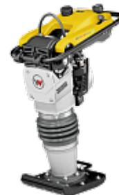
Профессиональная бензиновая вибротрамбовка Wacker Neuson BS 70-2 plus для максимального уплотнения для глубоких слоев засыпок. Вес вибротрамбовки 74 кг с ходом поршня на пяте 65 мм обеспечивает мощный амплитудный удар с максимальной частотой 687 ударов в минуту. Низкий центр тяжести обеспечивает удобство управления и высочайшую маневренность и податливость при работе с оборудованием.
