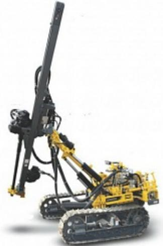
Податчик крепится к стреле через шарниры и отлично справляется не только с вертикальным, но и горизонтальным и наклонно вертикальным бурением. Несмотря на малый вес и скромные размеры Atlas Copco AirROC D35 является полноценной установкой без потерь функциональности.
