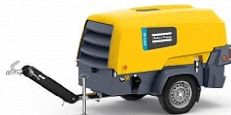
Компрессоры ХАТС 38 на шасси имеют одобрение типа транспортного средства, на них выдается ПТС, что позволяет поставить компрессор на учет в ГИБДД и буксировать его за автомобилем по дорогам общего пользования. Вес компрессора в максимальной комплектации менее 750 кг, поэтому водителю не требуется удостоверение категории ВЕ / СЕ.
