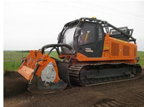
Прочная рама и качающееся шасси ходовая часть с герметичными смазанными гусеницами и роликами как у бульдозера, гарантируют продолжительный срок службы машины, тем самым уменьшая необходимость технического обслуживания и эксплуатационные расходы. Кабина оператора - чрезвычайно комфортная с отличной обзорностью, а плановое техническое обслуживание осуществляется легко и быстро, благодаря прекрасному доступу ко всем компонентам.
